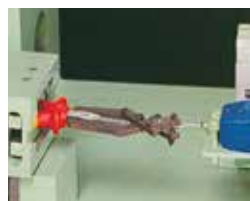
Prova di tenuta meccanica dei manici. Handles mechanical resistance test.
